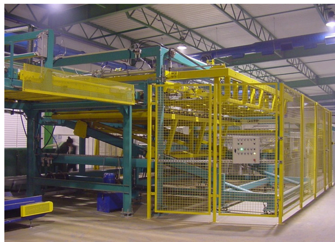
Automatyczny paletyzator płyt pilśniowych dużych gabarytów
