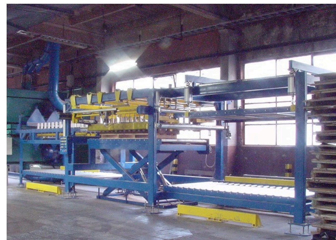
Automatyczny paletyzator płyt pilśniowych dużych gabarytów
